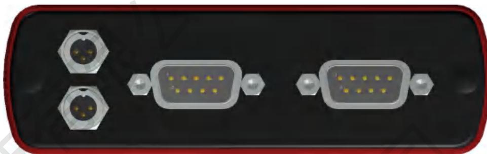
图23：带有同步和D-SUB9连接器的VN1630日志
